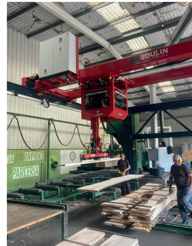
(planche/poutre). Alimentation de raboteuse, déligneuse, moulurière, centre d'usinage et en général toute manipulation de produits bois. La gamme de machines JOULIN assure une couverture complète de l'ensemble des applications possibles, avec la possibilité de réaliser des machines sur mesure dans les cas particuliers.
