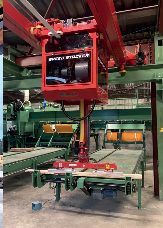
acte à châssis fermé, néanmoins facilement accessible grâce à ses portes d'accès montées sur vérins.
