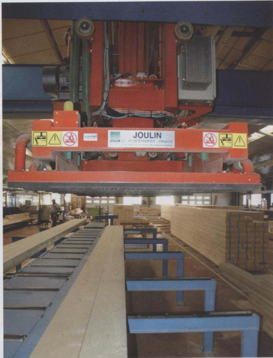
Le robot Joulin a une capacité de portage de 1.600 kg.
