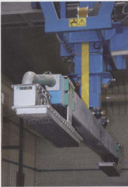
Portique de manutention équipé d'une ventouse Joulin pouvant porter 800 kg.
