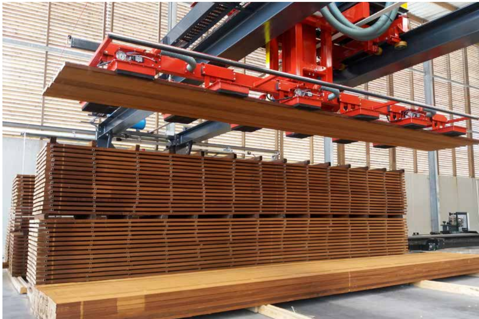
Zorgeloos, efficiënt en ergonomisch op- en aflatten voor en na drogen en modificeren. Het kan allemaal met slechts één operator in plaats van vier tot zes man die alles handmatig moeten verwerken.
