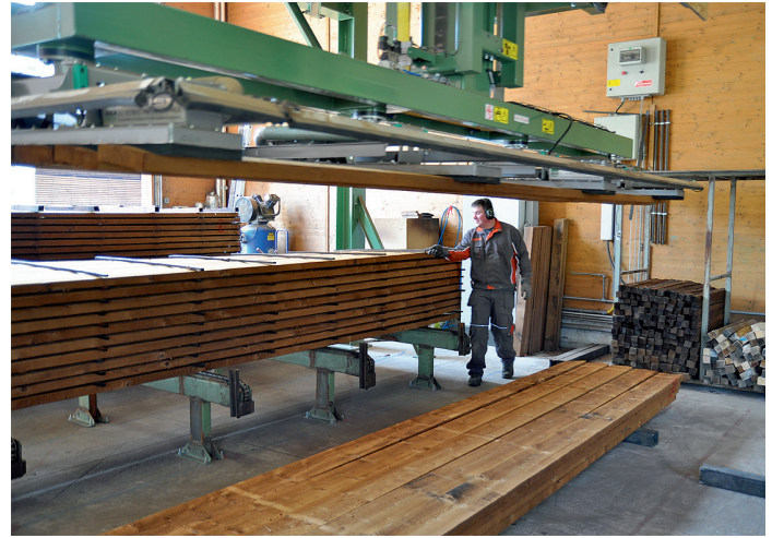
Effizientes Arbeiten ermöglicht der TS 1000 – die Mitarbeiter legen lediglich die Stapellatten noch selbst
