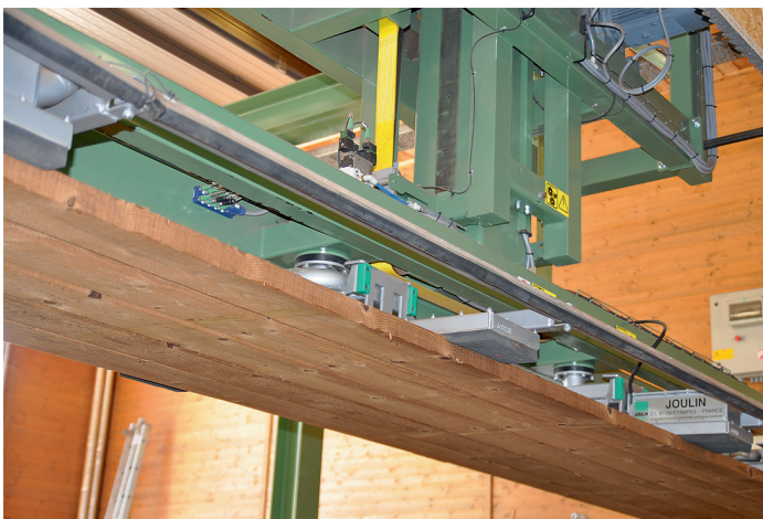
Unempfindlich gegen Staub und Spreiße: Wartungsarmes Arbeiten verspricht Joulin bei der Manipulation von Paketen und Einzelware
