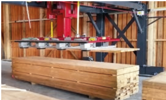
Apilador de 500 kg sobre estructura móvil. Capacidad máxima de 500 kg hasta 7 ciclos por minuto.
