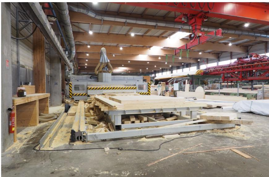
Le centre d'usinage Uniteam Extramix taille l'ensemble de la production de bois lamellé-croisé CLT de Monnet-Sève Sougy. Qu'il s'agisse d'éléments de murs ou de planchers, les panneaux de PLX sont livrés prêts à poser.
