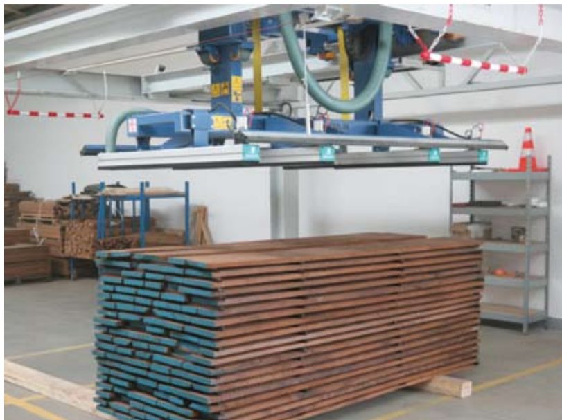
Ramię z czterema podciśnieniowymi chwytakami automatycznie opuszcza się na warstwę desek.
