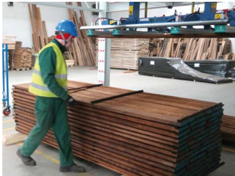
Bez przerywania pracy przenośnika możliwe jest ręczne nakładanie lub zdejmowanie nakładek.
